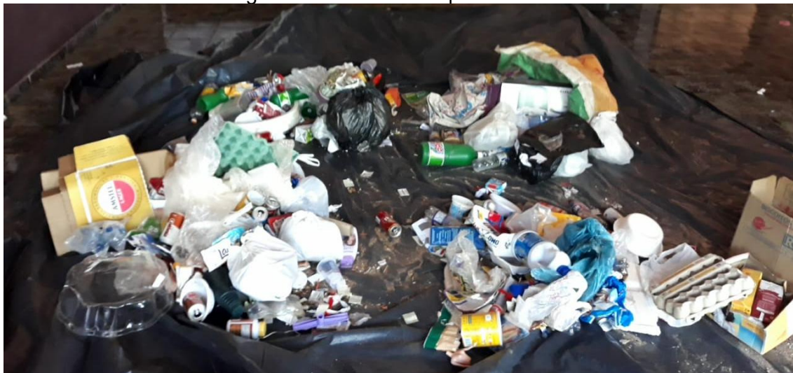
Figura 41 – Método de quartejamento.
